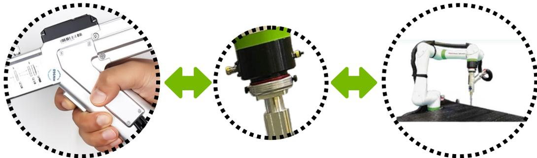
手動ツールチェンジャーにより、ハンド溶接とロボット溶接の切り替えがワンタッチで可能です。ロット数の多い製品や溶接長が長い製品はロボット溶接で、小ロット製品や複雑な溶接条件の時はハンド溶接でと、スピーディーに自動と手動の両立を図れます。
